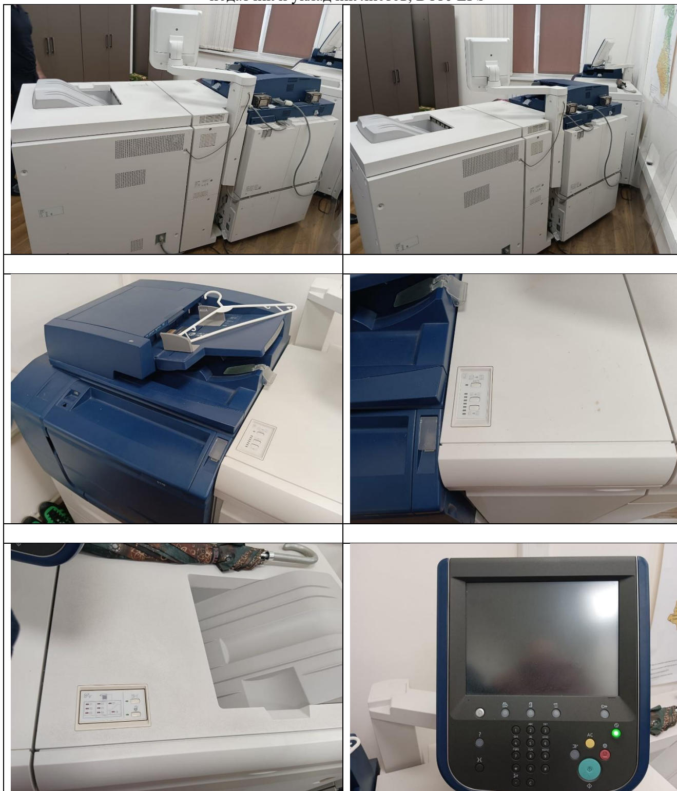
Цифровая печатная машина (Free flow + High Capacity Stacker) в комплекте с MSI, FTMS, FFPS - податчик и укладчик листов, D110 EPS
